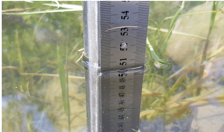
22.5.2019 16:30 Uhr: Niveau: Messlatte RFB 1 (links) und Referenzbehälter (rechts).
