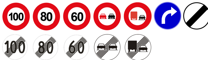
Fig. 2.4 Signaux de prescription VM en tunnel.
