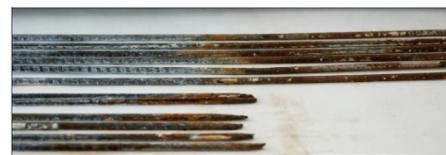
Abb. 2.34 Bruchstelle im Schrägseil Nr. 5 unterhalb des Pylonkopfs infolge Korrosion der Spanndrähte [12].
