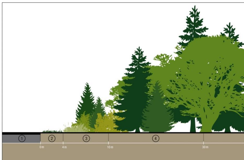
Fig. 3 Margine boschivo idealmente stratificato. 1: carreggiata; 2: zona a manutenzione intensiva; 3 e 4: zona a taglio alberi per motivi di sicurezza (rispettivamente fino a 10 m e da 10 a 30 m).
