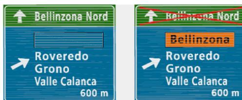
Fig. 5.1 Deviazione locale con località di destinazione riportata su segnale di preavviso.
