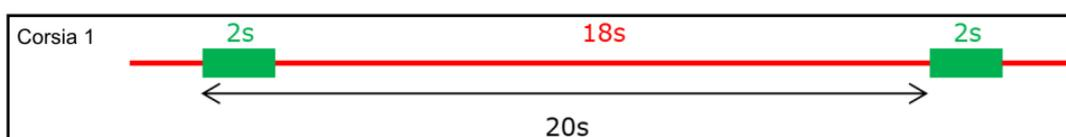
Fig. 5.6 Ripartizione della fase di semaforo verde e rosso nelle installazioni a una sola corsia con tempo di ciclo massimo (20 secondi)
