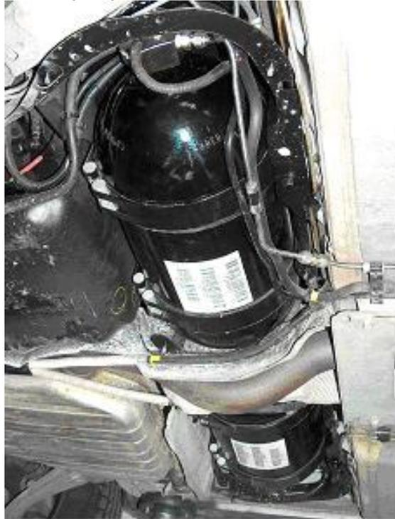
Réservoir en matériau composite (type cylindrique GNC-2)
