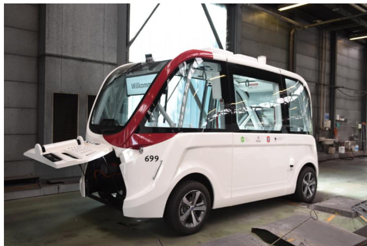
Figure 43 - Test de frein sur banc à rouleaux
