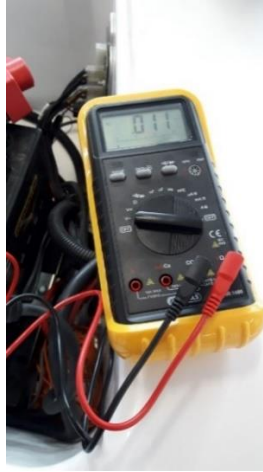
Figure 21 - Voltmètre attestant que la batterie 12 V est déchargée
