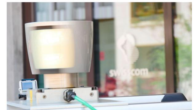
Dank des Laserscanners lassen sich Objekte genau orten – bei Tag und Nacht.
