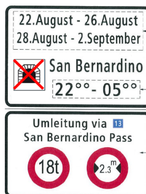
III. 6.1 Fermeture avec déviation du trafic lourd.
