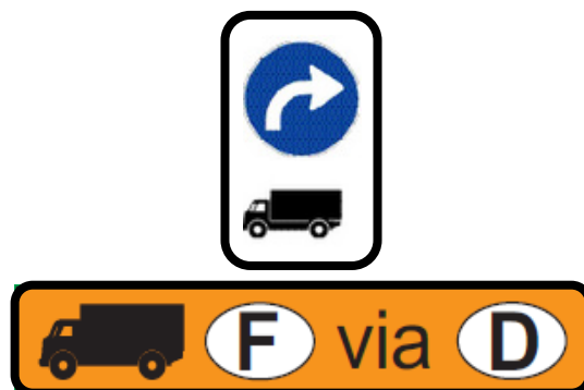
III. 6.2 Signaux placés au-dessus des voies de circulation pour la sortie forcée ou la déviation du trafic lourd.
