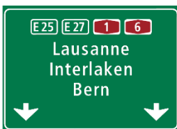
III. 4.2 Panneau de présélection au-dessus des voies de circulation des autoroutes.
