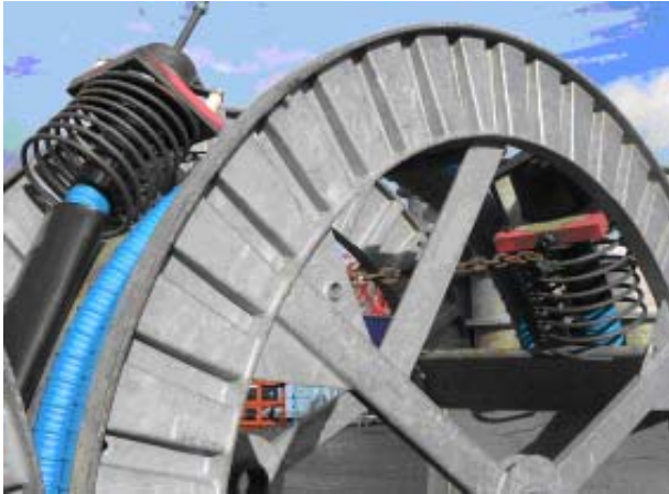
Fig. II.1 Câbles de précontrainte réalisés en usine, avec ancrages montés.
