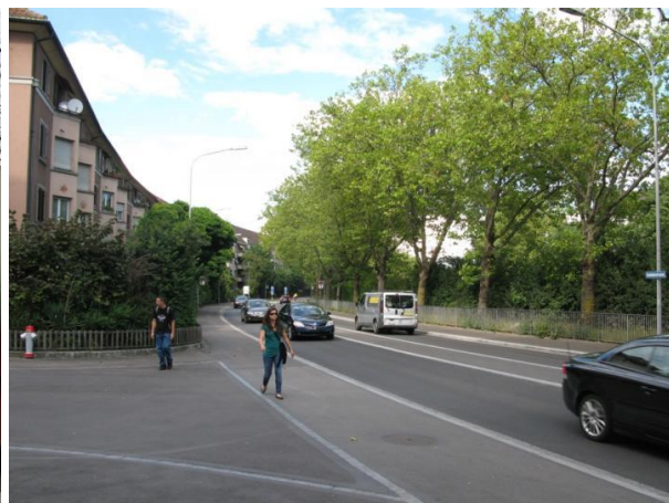
La Seebahnstrasse après transformation (2012) : route principale urbaine, trafic bidirectionnel avec bande centrale, report du trafic de transit sur le contournement ouest
