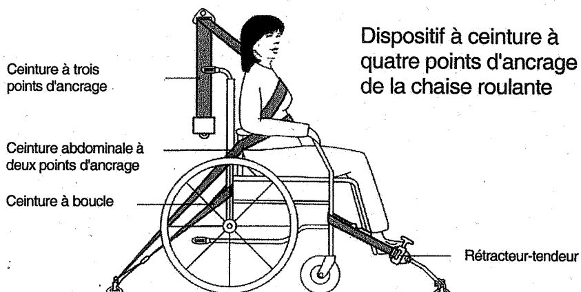
Figure 2 Dispositif de sécurité des personnes à trois point d'ancrage
