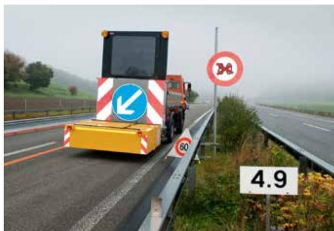
*Ce véhicule de signalisation est équipé d'un amortisseur de chocs à l'arrière.*
