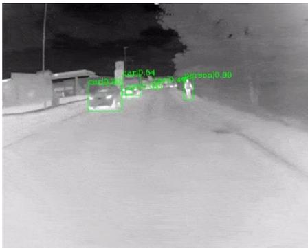
Figure 16 - Détection d'objets sur la caméra FLIR
