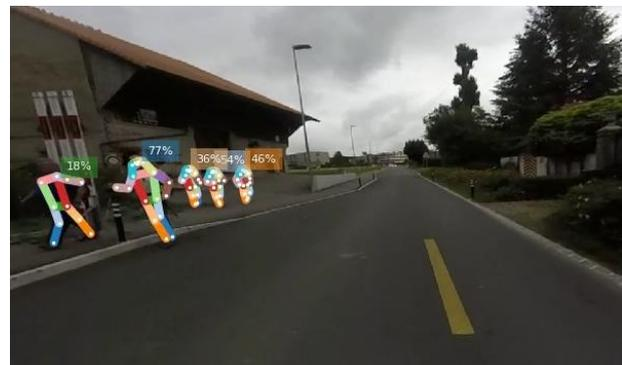
Figure 17 - Détection de piétons avec algo Vita Lab
