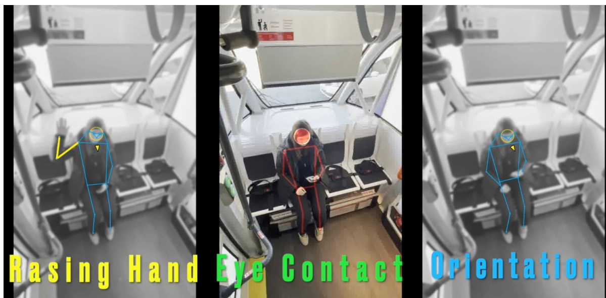
Illustration 13: Extrait de la caméra de surveillance simulant un scénario à détecter afin de porter assistance à l'utilisateur.
