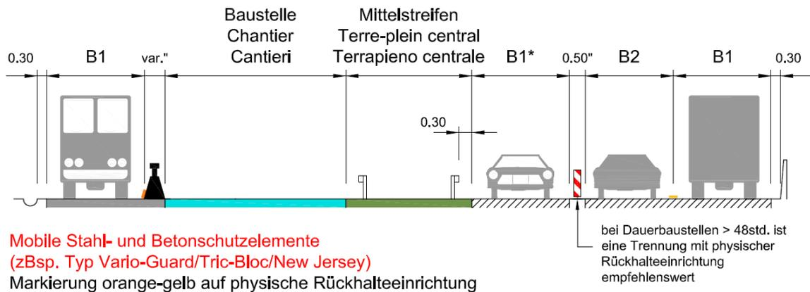
In speziellen Fällen, wo dies nicht möglich ist, und nur Absperrbaken zum Einsatz kommen, müssen diese mit einer temporären durchgehenden orange-gelben Randlinie ergänzt werden. Zudem wird ein Sicherheitsstreifen von 1.00m auf der dem Verkehr abgewandten Seite gefordert.
