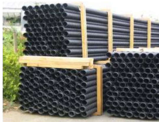
Abb. II.4: Richtige Lagerung der Hüllrohre.
