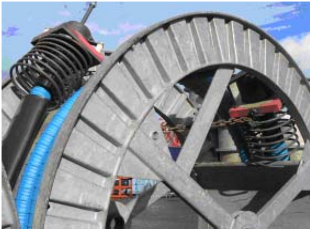
Abb. II.1: Werkgefertigte Spannglieder mit angebauten Verankerungen.
