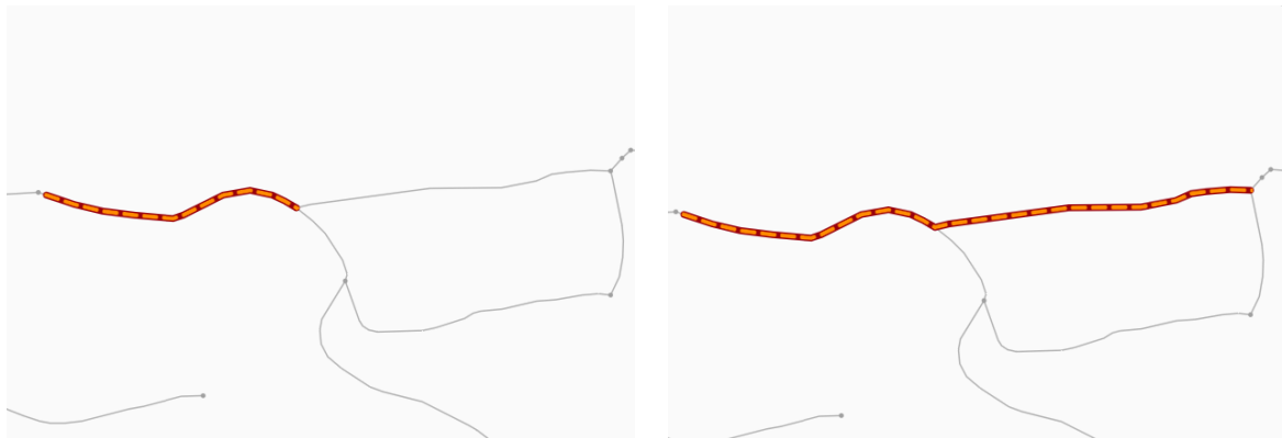
Abbildung 14 Netzabschnitt bilden: Mergen bei gleichen Eigenschaften
