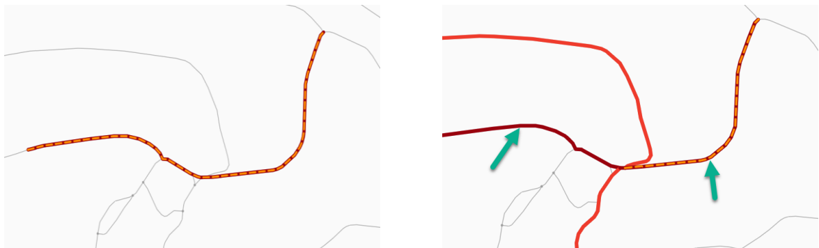
Abbildung 12 Netzabschnitt bilden: Splitten von bestehenden Abschnitten
