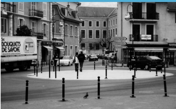
Die Vorteile der Kreisel nutzen, ohne dass dem Fussverkehr zusätzliche Umwege aufgezwungen werden: Das gut gelungene Beispiel in Chambéry in Frankreich zeigt, dass dies durchaus möglich ist.
