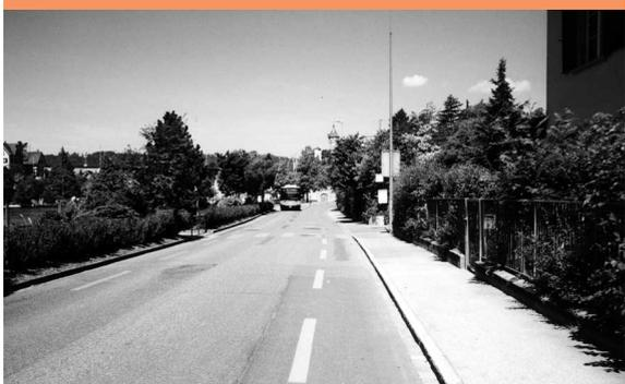
Ein besonders einfaches Mittel für eine verbesserte Sicherheit ist die so genannte «Kernfahrbahn». Ohne Mittelstreifen wird erfahrungsgemäss weniger schnell gefahren.
