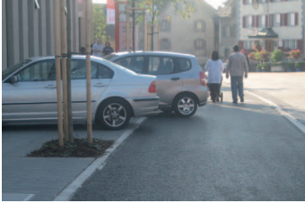
Die Parkierung ist so zu organisieren, dass keine Konflikte beim Manövrieren entstehen. In diesem Beispiel ist jeder Parkierungsvorgang mit einem Rückwärtsmanöver über das Trottoir verbunden.
