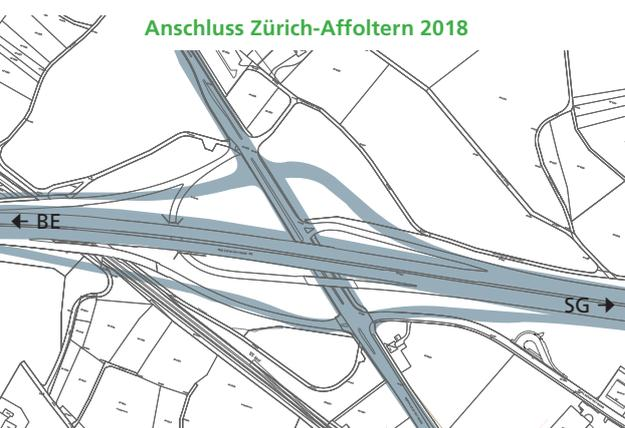
Der ausgebauter Anschluss beinhaltet die rautenförmige Anordnung der Ein- und Ausfahrtsrampen sowie Lichtsignalanlagen bei den Anschlussknoten.
