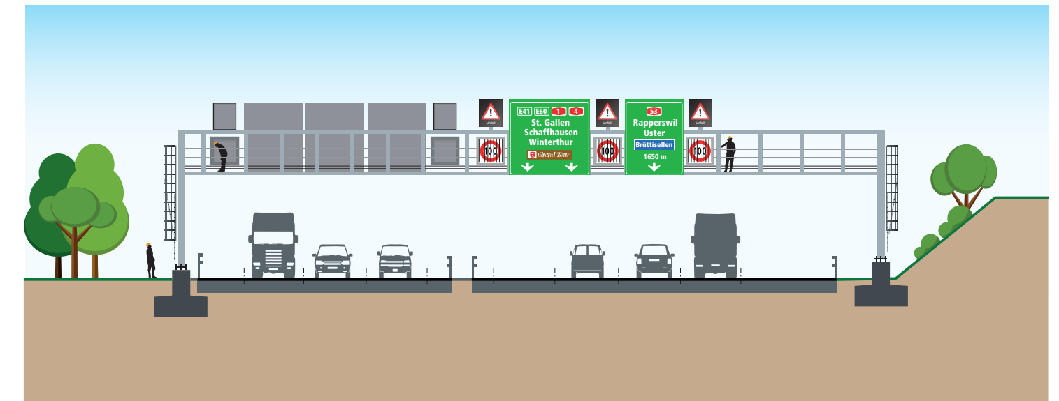
Zwischen Zürich-Nord und Effretikon werden 40 neue Signalportale realisiert.
