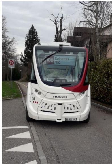
Figure 3 - Déviation de trajectoire dû à une mauvaise transition manuel / auto Source : TPF
