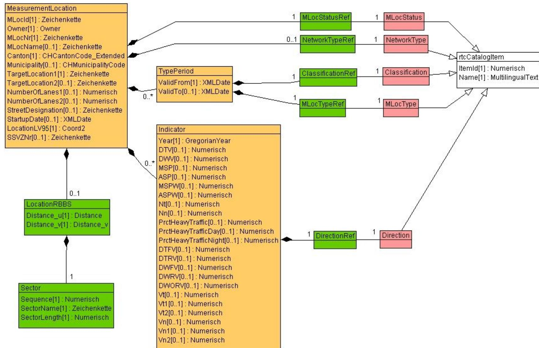
Minimales Geodatenmodell Strassenverkehrszählung
